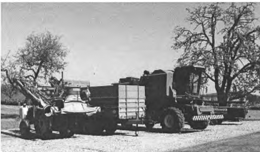
Abb. 10: Beim Abstellen im Freien entfallen Gebäudekosten. Schäden an Maschinen durch Korrosion treten jedoch häufiger auf.
