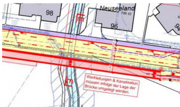
Abbildung 15 Anpassung Leitungen km 13.01
