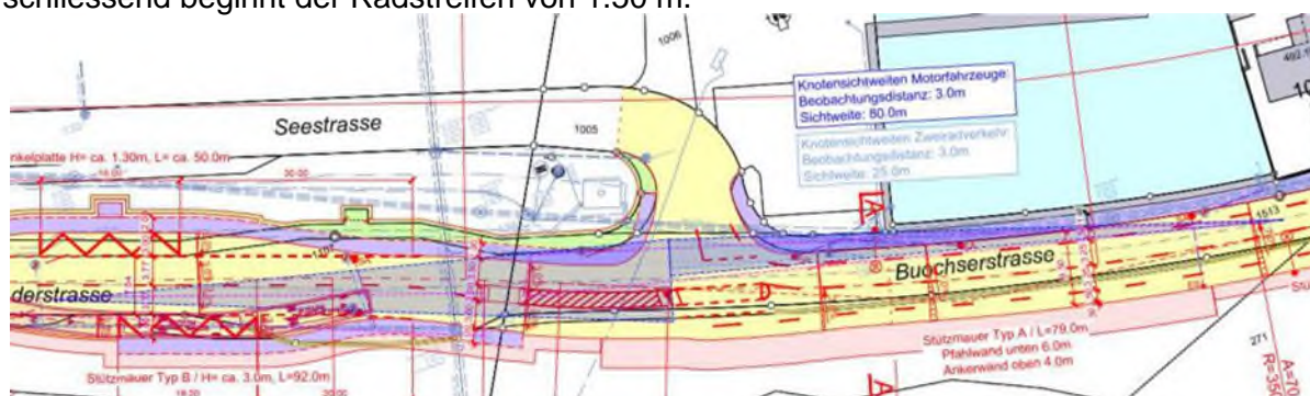
Abbildung 6 Vorprojekt, Situation Knoten Seestrasse, inkl. Sichtweiten
