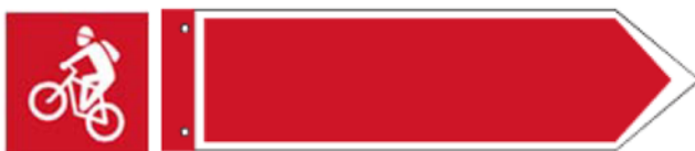
Abbildung 3: Wegweiser und Bestätigungen von offiziellen, legalisierten MTB-Wegen und MTB-Routen sind rot und enthalten ein weisses MTB-Piktogramm (gemäss VSS-Norm 640 829a).
