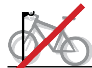
Lenkerhalter: Verbreitetes, aber ungeeignetes Parkiersystem. Wird wenig benutzt und beschädigt Brems-, Licht- und Schaltkabel
